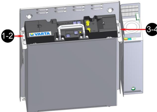
Abbildung 19: Befestigungsschrauben Batteriemodul
